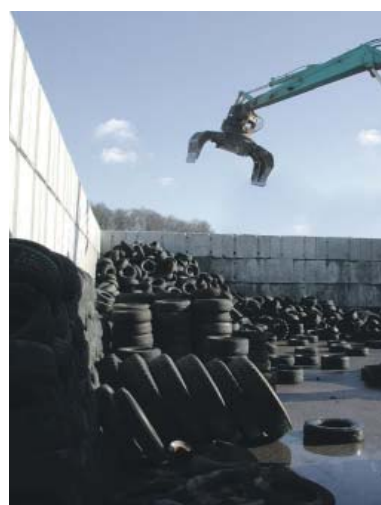
So nicht: Umschlag und Sortierung grösserer Mengen Altreifen immer unter Dach.
