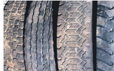
Reifen mit weniger als 1.6 mm Profiltiefe gelten als Abfall.
