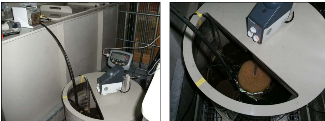
Abbildung 12: Dosiereinrichtung an der Pilot-ARA, mit der die Silberkonzentration im Zulauf eingestellt wird.
